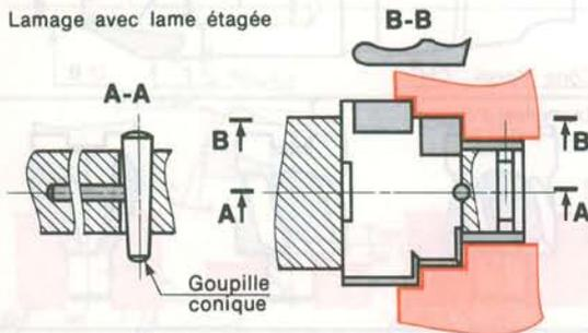
Ces lames amovibles offrent une grande plage en diamètres de lames et permettent la fabrication simple de profils spéciaux. Elles sont intéressantes pour les petites séries.
