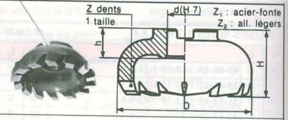
Fraises à grand rendement et robustes (grand logement de copeaux entre les dents et attaque de la matière par un chanfrein).
