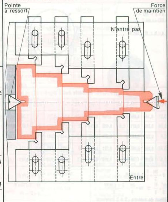
\* Les comparateurs sont étalonnés au préalable à l'aide de cales ou de pièces étalons.
