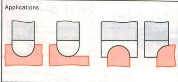
Pour ces fraises à profil constant, la dépouille est obtenue par « détalonnage » en spirale. L'affûtage se faisant sur la face de coupe, le profil est conservé.
