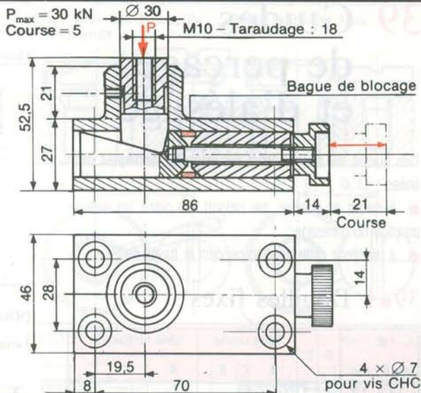
L'appareil débloqué, la touche est mise en position en tirant axialement le bouton moleté.
