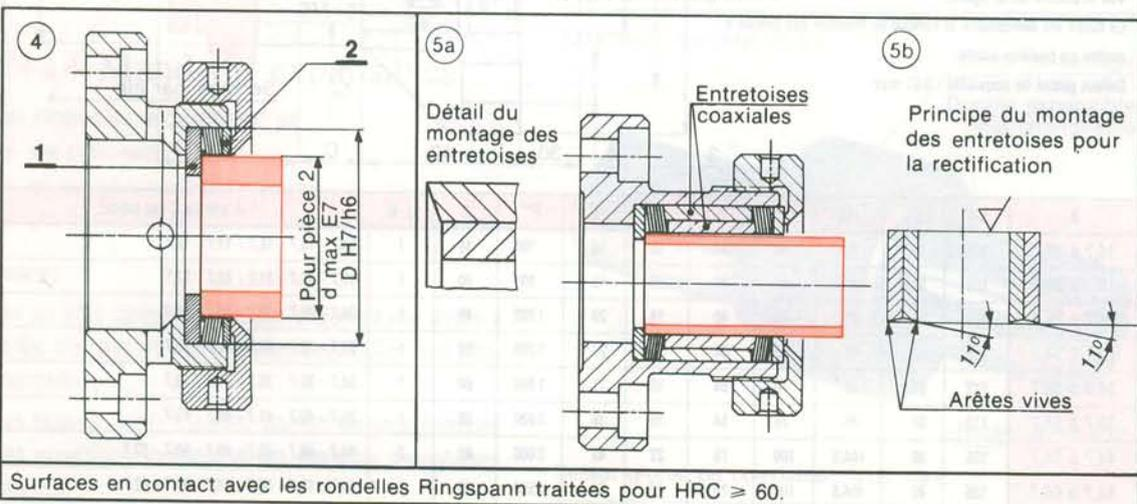
Dans cet exemple, l'action des rondelles Ringspann s'exerce sur la pièce par l'intermédiaire d'une douille élastique fendue. On évite ainsi toute marque sur la surface de serrage. La pièce est maintenue à l'autre extrémité par une pointe de centrage sur laquelle s'exerce la poussée d'un ensemble de rondelles Belleville.
