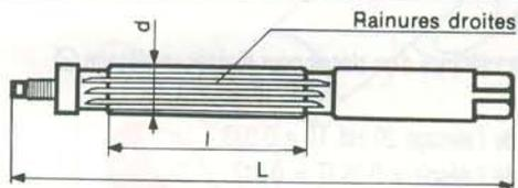
Le réglage radial s'effectue à l'aide d'une vis à bout conique. Il est limité par l'élasticité de l'acier et son amplitude est égale à  $d/100$ .EMPLOI : Alésage à la main (ajustage).
