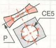
Le logiciel détermine le plan P passant par les points palpés. Les points sont projetés sur P et un cercle équivalent CE est obtenu.                  | 3.3.5                                 | Droite / droite              |                                                                                                                                                                                                                                                         |
