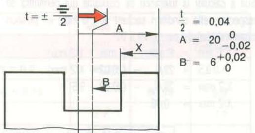
$$\begin{aligned} \frac{t}{2} &= 0,04 \\ A &= 20 \begin{matrix} 0 \\ -0,02 \end{matrix} \\ B &= 6 \begin{matrix} +0,02 \\ 0 \end{matrix} \end{aligned}$$
