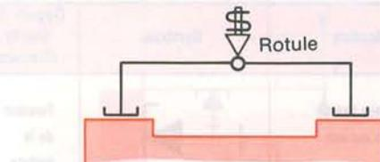
Système de bridage par palonnier comportant une articulation à rotule.
