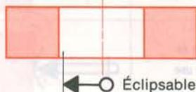
La pièce une fois mise en position, le dispositif de centrage doit pouvoir s'éclipser.
