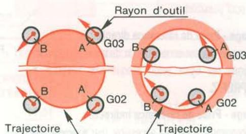
Contournage dans le plan G01- G02 - G03
