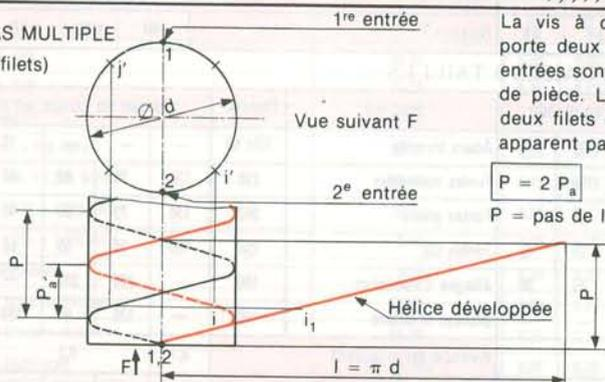
La vis à deux filets comporte deux hélices dont les entrées sont visibles en bout de pièce. La distance entre deux filets est égale au pas apparent pa.
