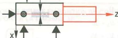
$\Delta f'$  = Dispersion due aux défauts de forme (circularité, cylindricité) de la surface en contact avec le porte-pièce.
