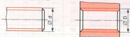
$D = d$  La vis et l'écrou ont le même diamètre nominal.
