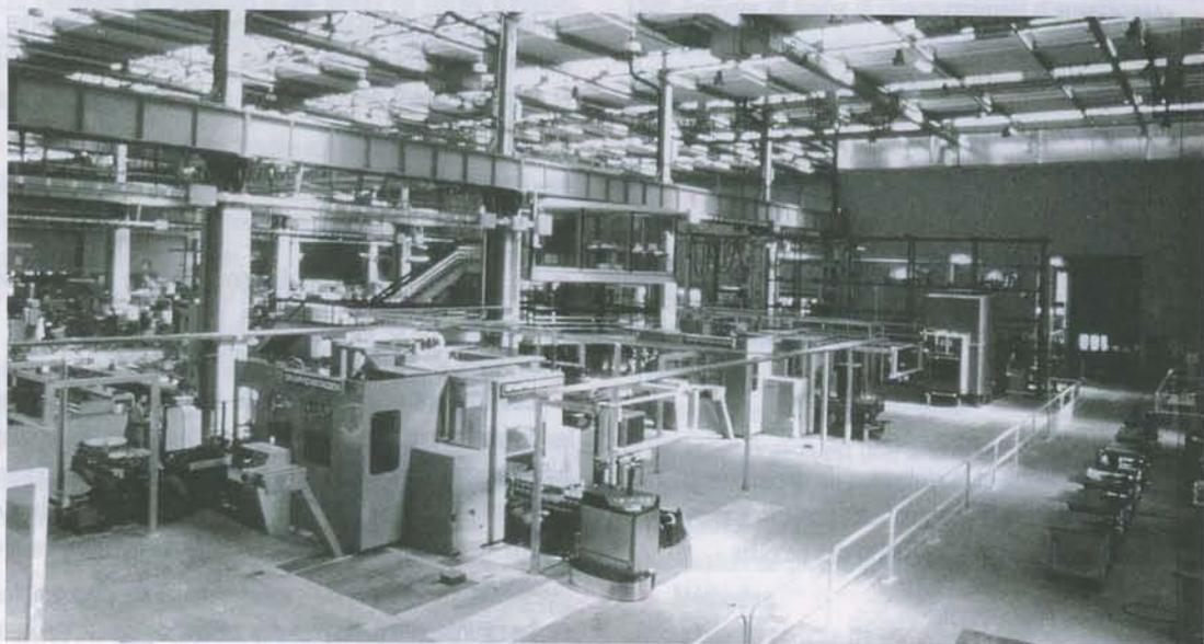
Cet atelier flexible composé de deux cellules flexibles permet l'usinage de toute pièce s'inscrivant dans un cube de 500 de côté avec la précision du 1/100. Le délai de fabrication de pièces mécaniques prototypes est réduit de 35 jours à 8 jours.
