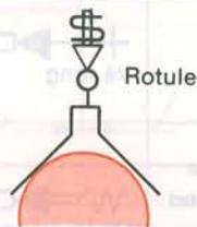
Le contact de l'élément de serrage avec la surface brute de la pièce s'effectue par l'intermédiaire d'un appui en vé monté sur une articulation à rotule.
