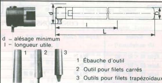
EMPLOI : Filetage intérieur de profils carrés ou trapézoïdaux.
