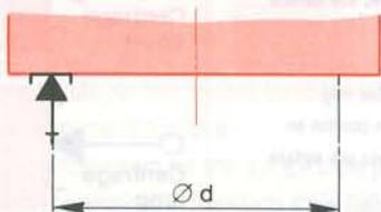
La surface usinée de la pièce est en appui fixe sur 3 touches plates disposées sur une circonférence et à 120° les unes des autres.
