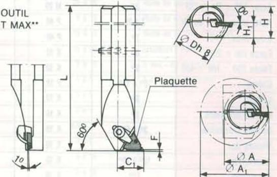
EMPLOI : Filetage intérieur de profils triangulaires ISO sur tour ou machine à fileter.
