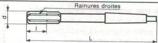
Le corps de la partie coupante est muni d'un cône intérieur rectifié, le réglage s'effectue à l'aide d'une cheville conique rectifiée; ainsi toutes les arêtes de coupe restent concentriques après l'ajustage.
