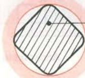
Section d'un centreur dégagé (éviter le dégagement triangulaire qui donne un contact moins correct et qui ne permet pas un contrôle aisé du diamètre)
