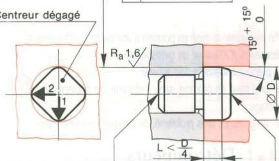
Traité pour  $HRC \geq 50$  Centres d'usinage admissibles
