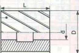
Fraises à grand rendement et robustes (grand logement de copeaux entre les dents et attaque par une portion de génératrice).
