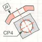
L'axe est perpendiculaire à P. Chaque point palpé est projeté sur P. Le plan P est préalablement mesuré ou construit. CP4 : Cercle projeté équivalent. | 3.3.4                                 | Surface / plan               |                                                                                                                                                                                                                                                         |
